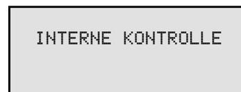
Nach dem Einschalten wird ca. 10 Sekunden lang der Text **INTERNE KONTROLLE** auf dem Display angezeigt. Anschließend wird das Hauptmenü (11 "Hauptmenü") angezeigt. Wird aus dem Hauptmenü nichts ausgewählt, schaltet das Gerät automatisch auf den (8.2 "Betriebszustände").
