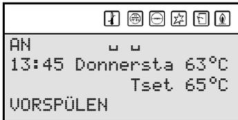
3. Während der Vorbelüftung wird der Druckschalter geschlossen.
