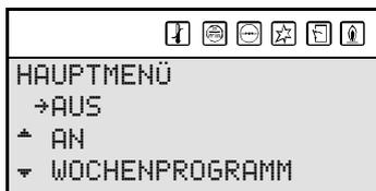
5. Drücken Sie ein Mal auf den blauen Pfeil (⇩), um den Cursor vor **AN** zu setzen und drücken Sie anschließend **ENTER**. Daraufhin wird der in der Abbildung wiedergegebene Bildschirm angezeigt.
