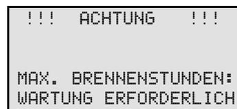
Auf dem Display erscheint nach Ablauf der eingestellten Brennstunden die Meldung **WARTUNG ERFORDERLICH**. Nach dem Anzeigen dieser Meldung sollten Sie den Service-Techniker kontaktieren.
