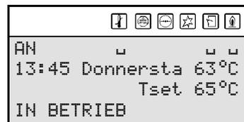
7. Sobald das Wasser die richtige Temperatur erreicht hat, besteht kein Wärmebedarf mehr und die Nachbelüftung beginnt. Dies dauert ungefähr 25 Sekunden.
