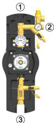
4. Raccordez la station de pompage solaire au système avec la tuyauterie :
