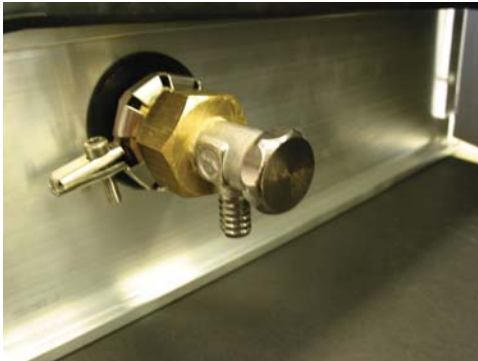
Komplett montierter Entlüfter. Alle anderen Verbindungen wie auch die Abdeckungen werden in gleicher Weise montiert.
